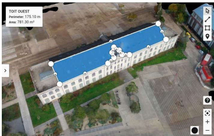
A l'aide de cette solution, le professionnel peut effectuer le métré de tout type de bâtiment et des relevés dimensionnels en toute sécurité, de manière fiable et exhaustive sur une maquette numérique 3D texturée obtenue grâce aux données et photos recueillies par le drone.
